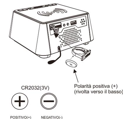
La batteria di backup serve solo per mantenere le impostazioni di ora e allarme durante l'interruzione di alimentazione. Quando l'alimentazione della batteria è scarica al di sotto di un certo livello, l'indicatore BATTERIA SCARICA si mette a "lampeggiare". Occorre sostituire la batteria con una nuova batteria di 3V al litio CR2032 o equivalente come segue:
